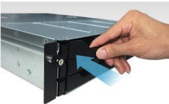
5. Закрепленную защелку можно заблокировать фиксатором лотка для дисков. Возьмите отвертку с плоской головкой и поверните фиксатор против часовой стрелки, чтобы заблокировать механизм защелки. Чтобы разблокировать механизм, поверните фиксатор по часовой стрелке.
