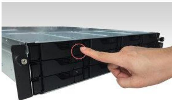
2. С помощью фиксатора осторожно вытяните лоток для диска из дискового отсека.
