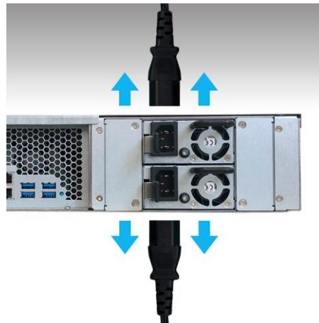
2. Нажмите на рычаг источника питания на задней панели в указанном направлении.
