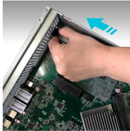
2. Осторожно вставьте плату расширения в гнездо, совмещая разъем в нижней части платы расширения с гнездом.
