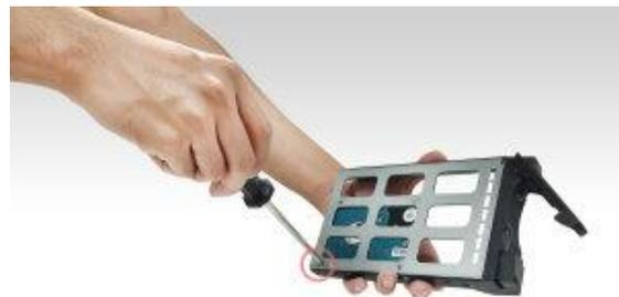
4. Задвиньте лоток по направляющим в отсек для диска. С помощью фиксатора осторожно продвиньте лоток для диска в дисковый отсек. Опустив фиксатор, закрепите лоток для диска на месте. Фиксатор должен перемещаться легко и зафиксироваться на месте с щелчком. Перед защелкиванием фиксатора убедитесь, что лоток для диска полностью вошел в дисковый отсек.
