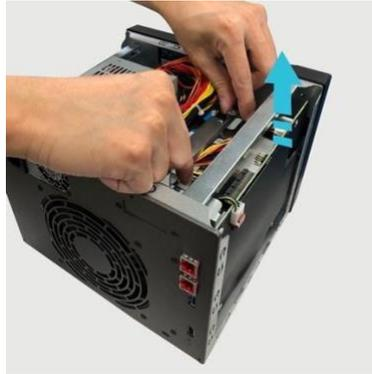
5. Quite ambos tornillos en la parte posterior del NAS y el soporte marcador de posición.
