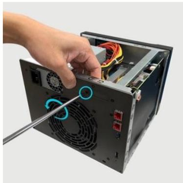
6. Desatornille y retire el soporte de altura completa de la tarjeta de red AS-T10G2. La instalación de [AS-T10G2](#) requiere el uso del soporte incluido, diseñado para la serie de dispositivos NAS Lockerstor Gen2.
