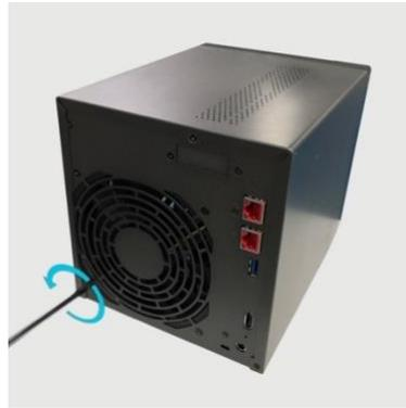
4. Sitúa el soporte sobre el agujero del tornillo que has quitado. Fija el soporte volviendo a poner el tornillo del ventilador.
