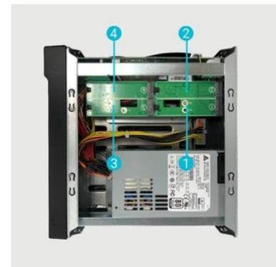
2. Inserte el SSD M.2 en ángulo, alinee la muesca con el conector e inserte la unidad M.2. Asegúrese de que el SSD M.2 esté completamente insertado, sostenga la palanca de plástico y presione hacia abajo el SSD M.2 hasta que encaje en la ranura.
