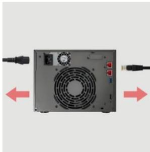
El zócalo PCIe integrado en su NAS no admite la funcionalidad de intercambio en caliente. Apague y desconecte su NAS antes de cambiar entre dispositivos PCIe.
