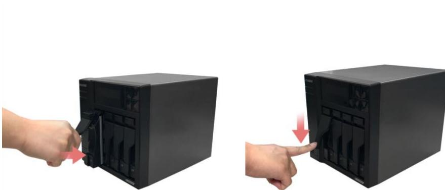
5. Una vez que el pestillo está asegurado, puede bloquearlo mediante el seguro de la bandeja de discos. Con la ayuda de un destornillador de cabeza plana, gire el seguro en sentido antihorario para bloquear el mecanismo de cierre. Para desbloquearlo, gire el candado en sentido horario.
