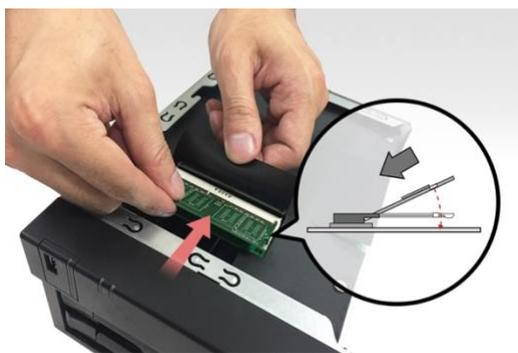
2. Empuje suavemente el DIMM hacia abajo, hasta que ambos pestillos encajen en su lugar. La RAM debe estar alineada con la placa base.
