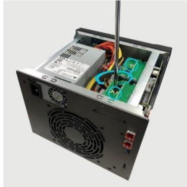
2. Extraiga suavemente la tarjeta M.2 de la ranura PCIe, como se muestra a continuación.
