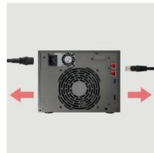
3. Utilice un destornillador para aflojar los tres tornillos situados en la parte posterior del NAS, tal como se muestra en la imagen.
