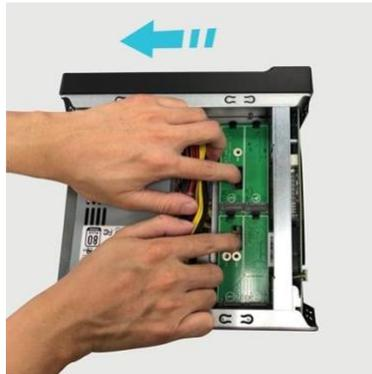
3. Quite los dos tornillos que sujetan el soporte para la tarjeta M.2.
